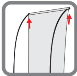
**6** Finalmente coloque las varillas de fibra de vidrio e insértela en las perforaciones de varilla superior del banner
